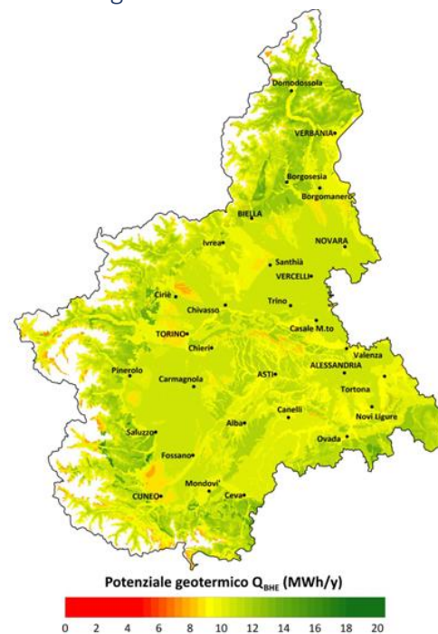
Figura 2.24 – Mappa del potenziale geotermico a circuito chiuso ( Q_{BHE} ), in scala 1:1.5M, con l'esclusione della fascia altimetrica sopra i 2000 m s.l.m.
